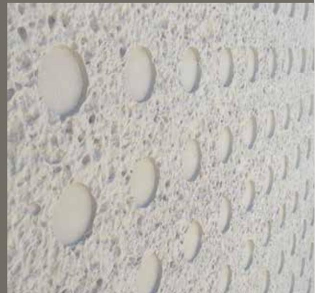
Avec le GRC, il a toujours été possible de réaliser des surfaces spéciales. Que ce soit en raison d'une tendance du marché ou de l'amélioration des techniques de production, de plus en plus de projets émergent avec des surfaces spéciales, et les architectes demandent de plus en plus une plus grande variété d'options.
