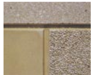
Polierte, geätzte und abgetragene Oberfläche mit Glen Sanda 4/8 (schottischer Zuschlagstoff)
