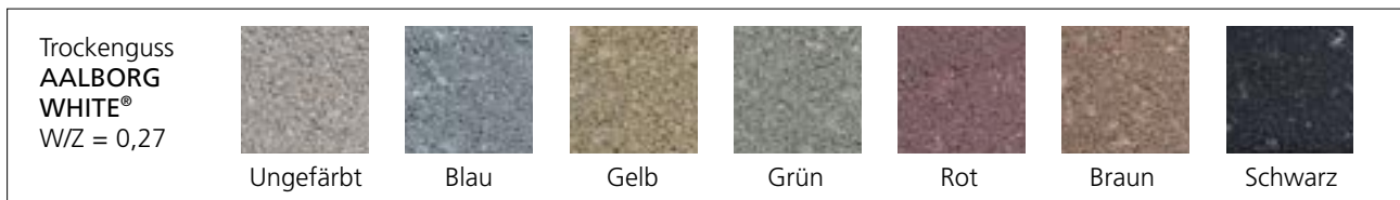
Abhängigkeit der Farbschattierungsskala für W/Z-Verhältnis mit AALBORG WHITE®.
