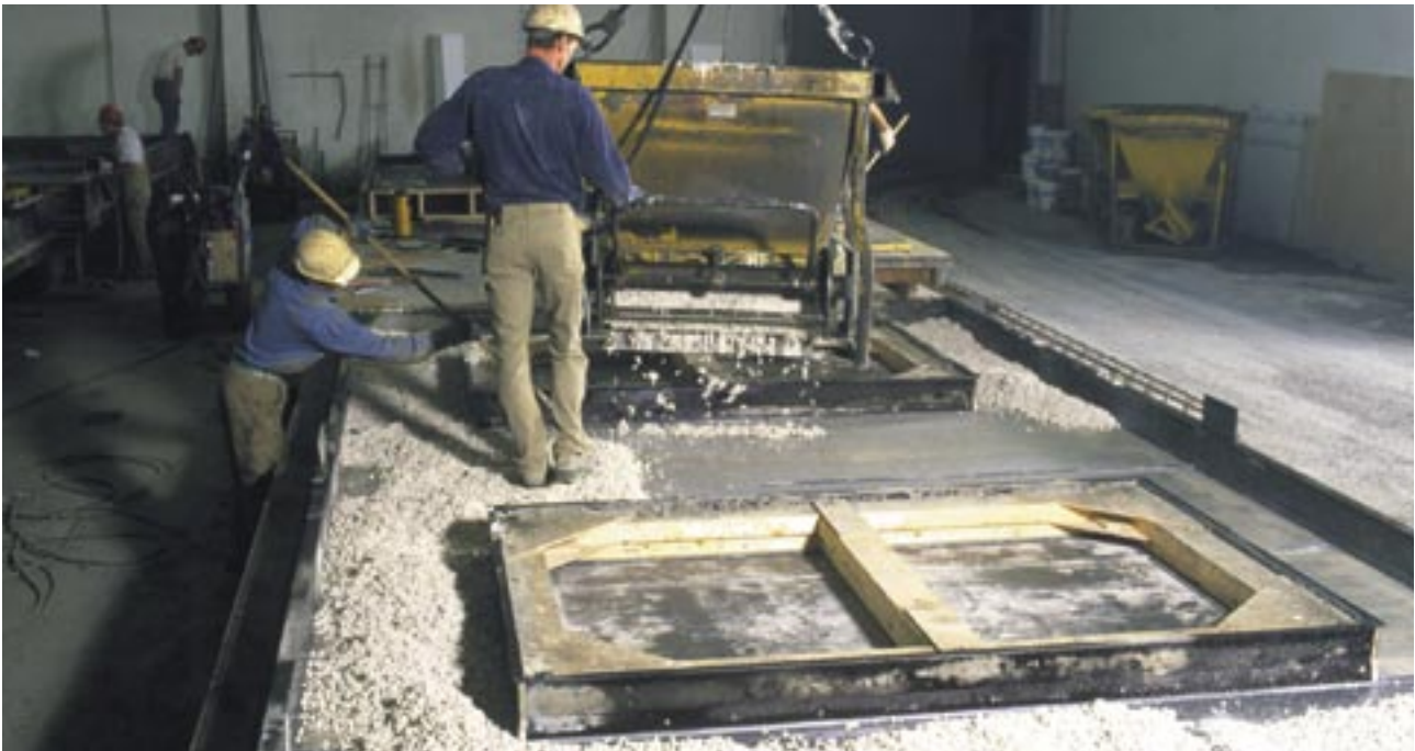
Rütteltisch für sichtbare Betonelemente.
