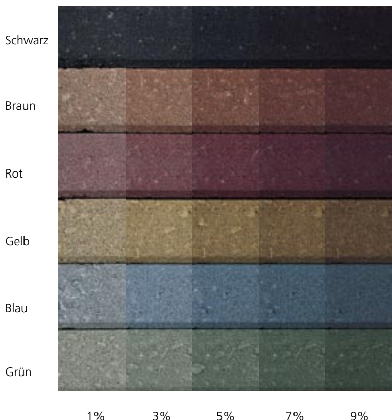
Farbintensität abhängig von der Dosierung mit zugehöriger Farbschattierungsskala.
