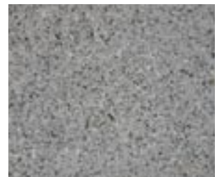
Geätzte Oberfläche mit Bayergrün 10/20 (deutscher Zuschlagstoff)
