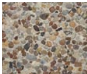
Abgetragene Oberfläche mit Kies aus feinen Kieseln 16/32
