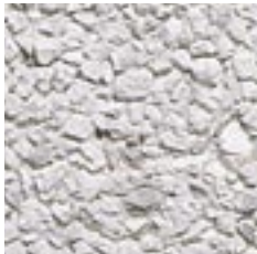
Abgetragener Beton mit grobem, weißem Marmor nach dem Schleifen, mit Verzögerer
